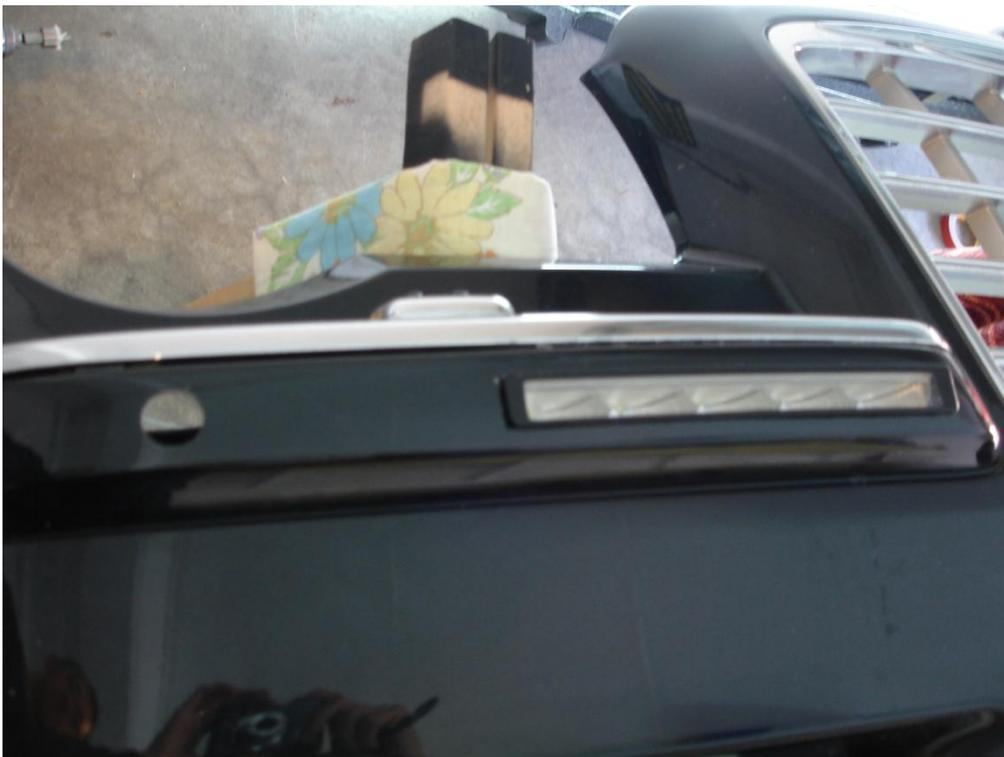
Anschliessend an die Feinarbeit der TFL sind die Löcher der Sensoren schnell gemacht. Meistens ist ein Bohrer bei den Sensoren mitgeliefert, in meinem Fall ein 21mm Bohrer. An den Markierten Stellen ansetzen, mit leichtem Druck von Aussen durchbohren. Darauf achten dass der Bohrer in Gutem Zustand ist, nicht dass es etwas wegreisst beim Bohren.
