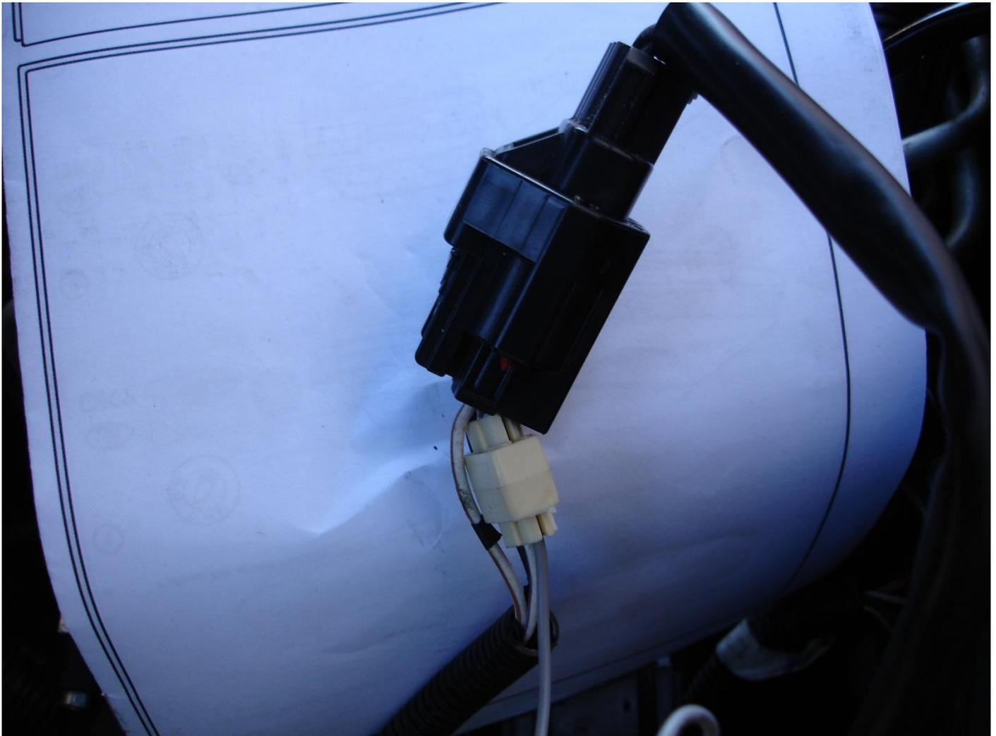
Jetzt muss man noch den Kontakt zum Standlicht herstellen damit das integrierte Relais in den TFL schalten kann. Hier muss mit einem Prüfgerät der richtige Draht gefunden werden (das + Kabel nehmen). Mit dem mitgelieferten Stecker verbinden.
